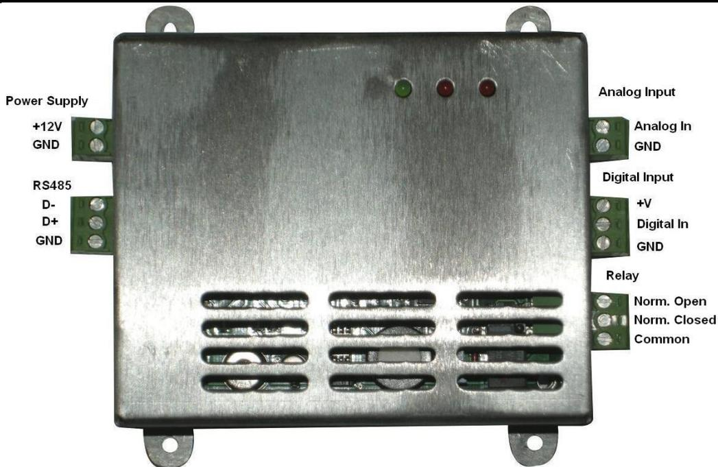
Fig. 1 Wiring Diagram
