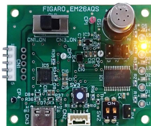
图 2 LED 亮灯状态 (图例为 D4 亮灯)
