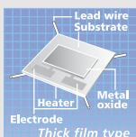
スクリーン印刷技術を応用し自動化設備による大量生産を実現した印刷タイプのガスセンサです。安定した品質でガス警報器から空調・家電まで幅広いニーズに対応します。
