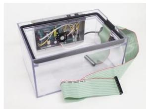
評価用ガスセンサ試験槽
