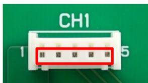
ガスセンサ評価用モジュールの端子をモジュール用コネクタの大きい方の穴へ挿し込みます。
