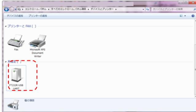
図5 USB ドライバーアイコン (デバイスとプリンターの表示画面)
